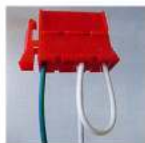
* Brücke zwischen C7 und C8
